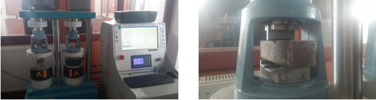
Şekil 3. Eğilme dayanımı deneyi düzeneği
