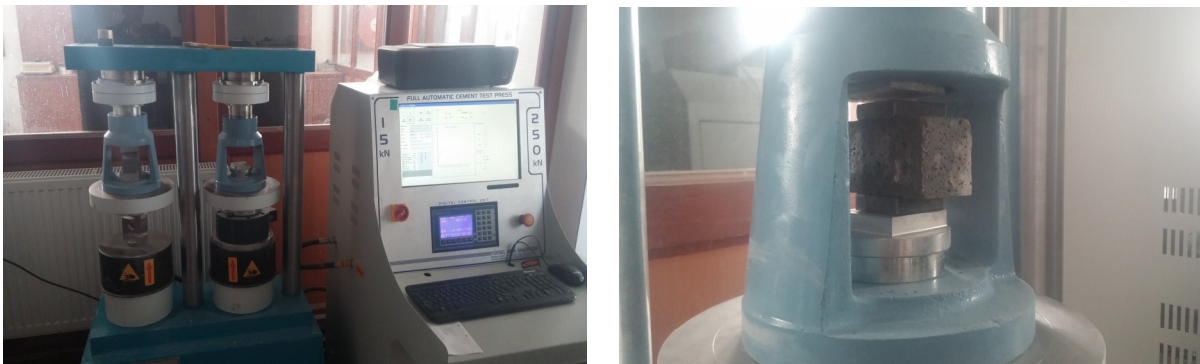
Şekil 6. Basınç dayanımı deneyi düzeneği ve basınç deneyi başlığı
