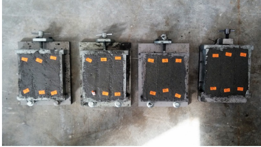
Şekil 1. Kalıplara dökülmüş harç numuneleri
