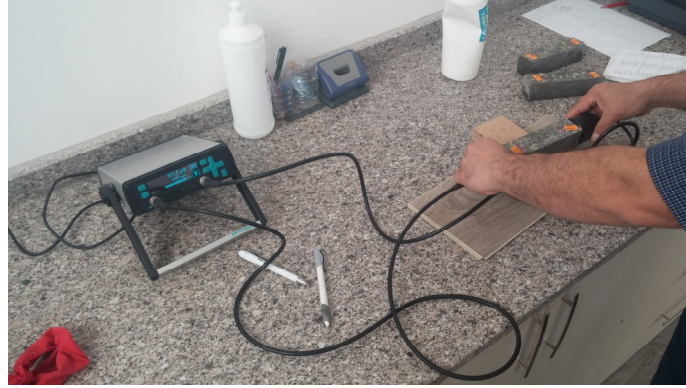
Şekil 7. Numunelerin ultrases geçiş hız değerlerinin belirlenmesi
