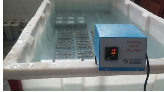
Şekil 2. Numunelerin kür havuzunda bekleme durumları
